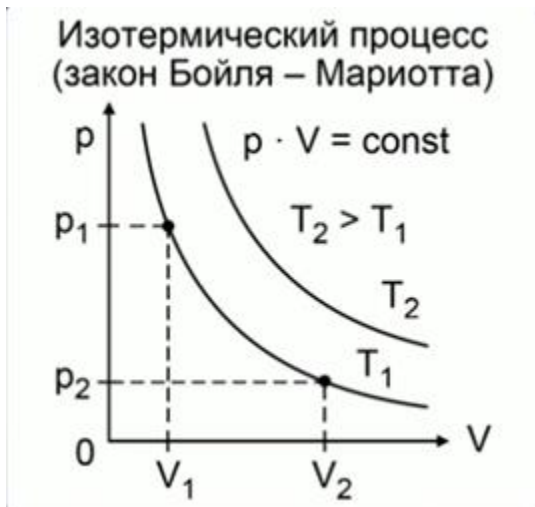
Рис. 13. Изотермический процесс в пространстве давления и объема.
